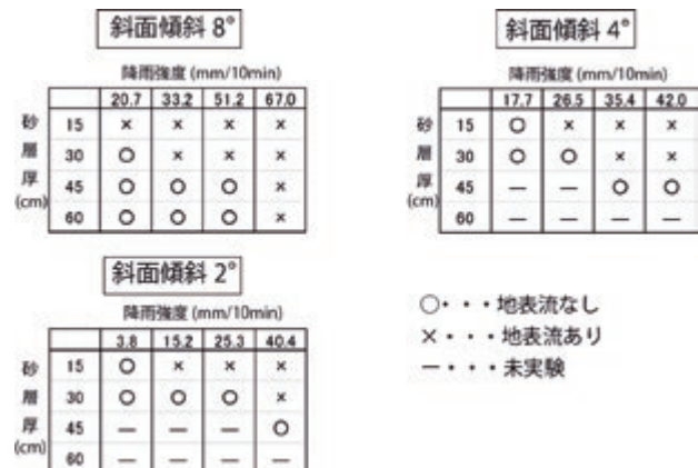
図 9 実験水槽装置の傾斜と降雨強度に応じた地表流発生の有無
