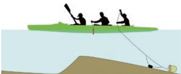
図 4 ドレッジ式底質採取の模式図
