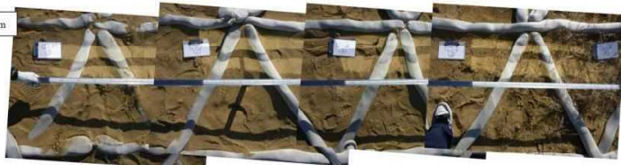
図 13 太陽光線を反射させてつくった水平棒の影を用いた砂面高の計測例
