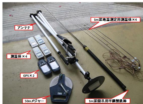
図 2-2-1 1m 深地温探査ならびに GPS 測量のために使用した機器
