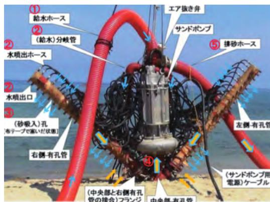
写真3 鳥取方式サンドポンプ (鳥取県HPより参照)
